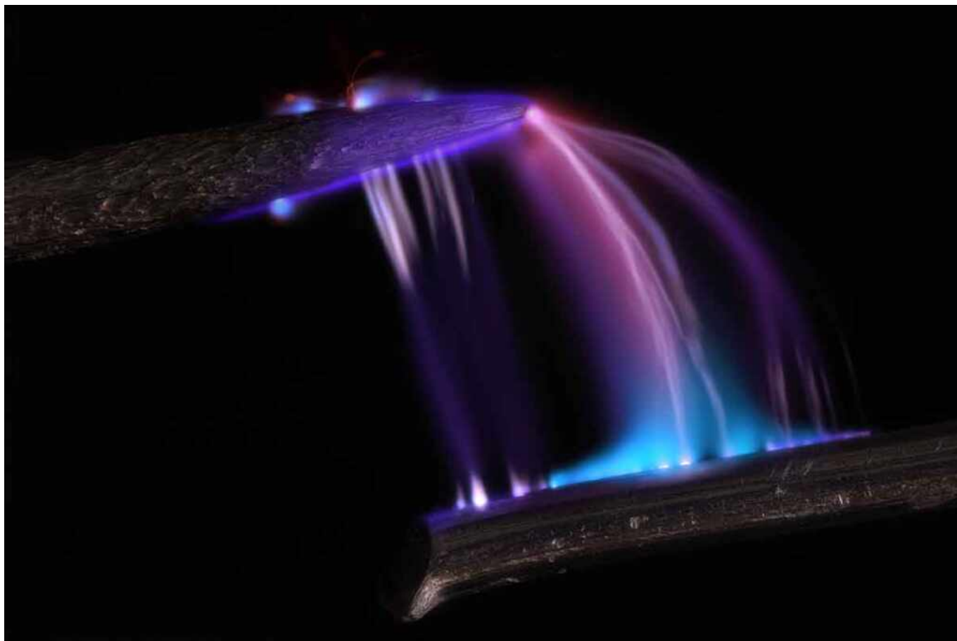
Arco elettrico tra uno spillo e un filo. Credit: Dr. Marcel Clemens
