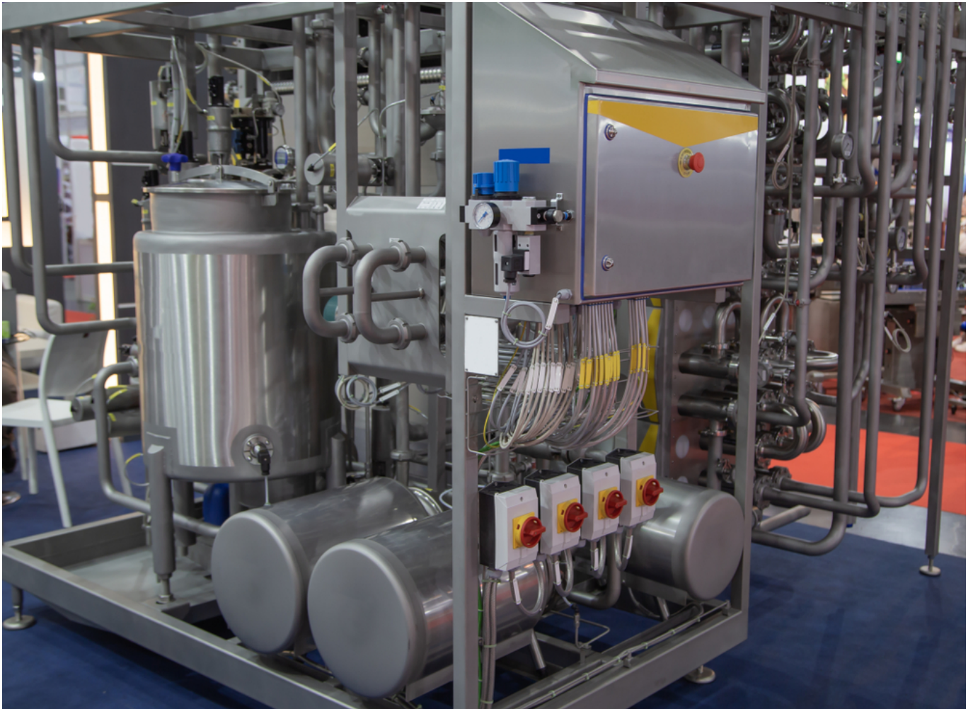
Impianto di pastorizzazione UHT, utilizzato nell'industria alimentare per il trattamento termico e la conservazione a lunga durata di latte
